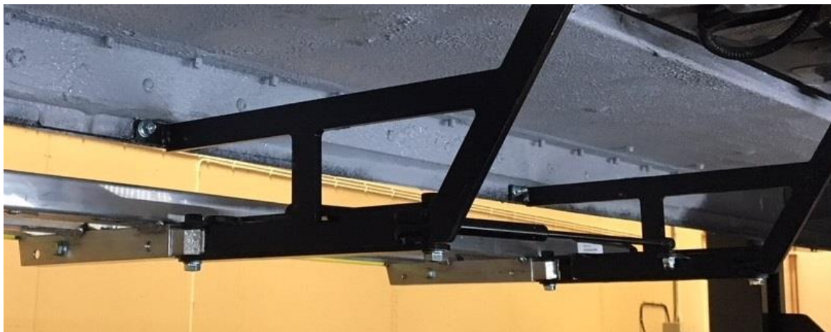
Bild 4. Främre och mittersta konsolen med gasdämpare monterad
